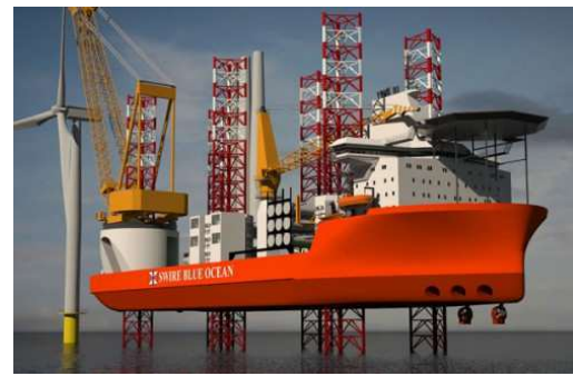
(d) Wind farm jack-up with truss legs
